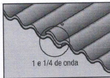
Recobrimento lateral 1 e 1/4 de onda
